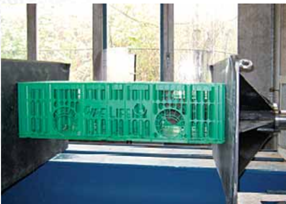
Lastwiderstandstest der Stormbox
