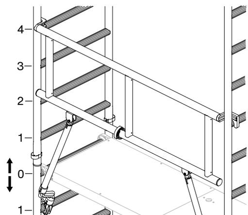
1. Hängen Sie das Sicherheits-Geländer mithilfe der Gerüstkonsolen in den profilierten Sprossen der Aufsteckrahmen ein.
