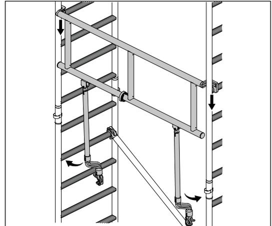
3. Achten Sie darauf, dass die Gerüstklauen an den profilierten Sprossen gesichert sind, um ein ungewolltes Lösen der Diagonalstreben zu verhindern.
