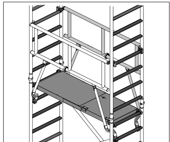
7. Montieren Sie an der obersten Position, die passenden Geländerrahmen.
