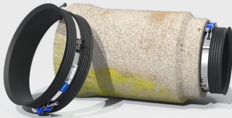
Eine einzigartige Manschette, die sicher an den Innenwänden zweier Rohre abdichtet und von außen verspannt wird! Das EPDM Profil dichtet in Verbindung mit einer speziellen Spanmechanik Abwasserrohre von DN 150 bis DN 600 wasser- und luftdicht ab.
