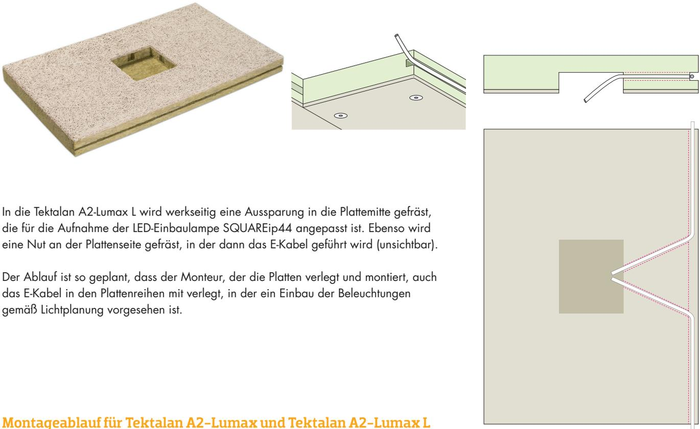
In die Tektalan A2-Lumax L wird werkseitig eine Aussparung in die Plattenmitte gefräst, die für die Aufnahme der LED-Einbaulampe SQUAREip44 angepasst ist. Ebenso wird eine Nut an der Plattenseite gefräst, in der dann das E-Kabel geführt wird (unsichtbar).
