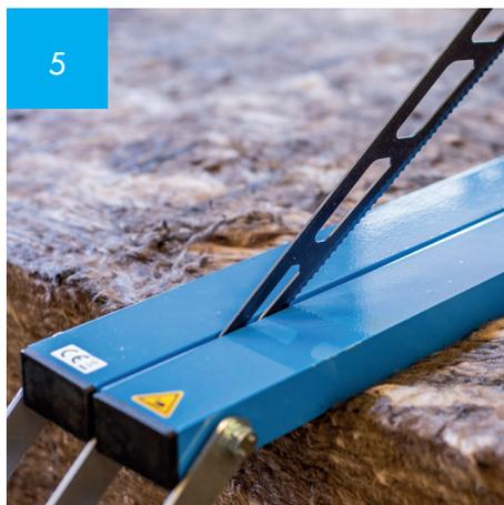
Das Dämmstoffmesser an einer Seite in beide Führungsschlitze (oben und unten) einführen.
