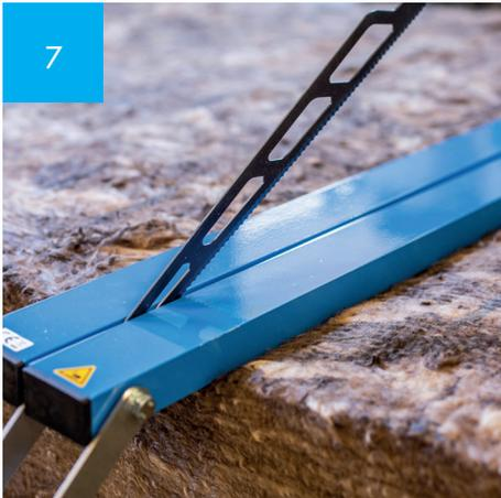
Nach dem kompletten Durchschnitt kann das Dämmstoffmesser entfernt werden und die Holme können wieder geöffnet werden.
