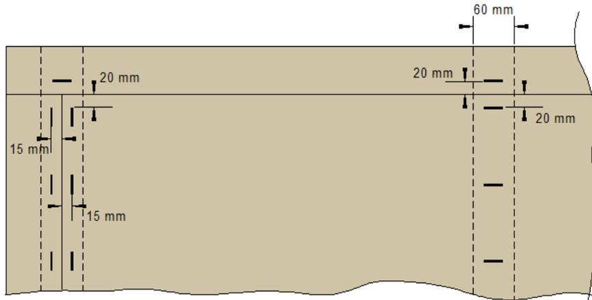
Hinweis: Der Randabstand der Klammer im Holz muss  $\geq 5 d_n$  betragen ( $\geq 10$  mm), der Abstand zum Plattenrand (Tektalan A2-FP/HB)  $\geq 7 d_n$  (14 mm).
