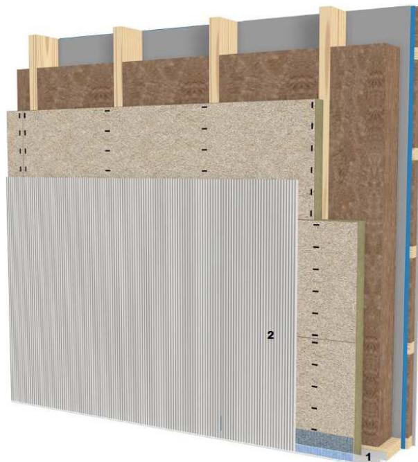
Vorteil: Die Dämmplatten erhalten somit einen temporären Wetterschutz und sind vor Feuchteinwirkungen geschützt! Die Wände sind bis zur Trocknung der Vorbeschichtung frostfrei zu lagern! Die Stand- und Trocknungszeit bis zum Transport zur Baustelle (Abhängig vom Raumklima der Lagerstätte) beträgt mindestens 3 Tage!
