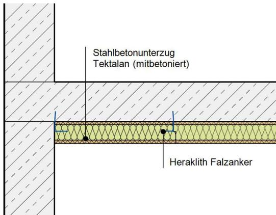
Zu angrenzenden Bauteilen und in Eckbereichen ist der Stufenfalz abzuschneiden.
