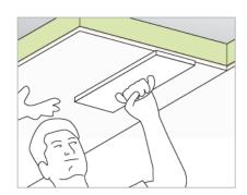
Der Kleber ist vollflächig auf die Plattenrückseite aufzubringen und abzukämmen. Die Größe des Zahnspachtels sowie die Klebermenge sind abhängig von der gewählten Plattendicke. Durch die Haftbeschichtung ist auch ein maschineller Klebemörtelauftrag möglich. Der unmittelbare Plattenrand (ca. 1 cm) sollte frei von Kleber bleiben, damit beim Anbringen der Platte kein Kleber in die Plattenstöße gedrückt wird.
