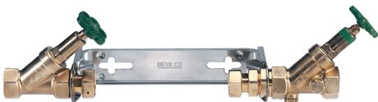
Wasserzähler-Anschlussgarnitur für waagerechten oder senkrechten Einbau mit eingangsseitigem Freistromventil und ausgangsseitigem KFR-Ventil. Ausführung starr oder dem Wandabstand entsprechend verstellbar.
