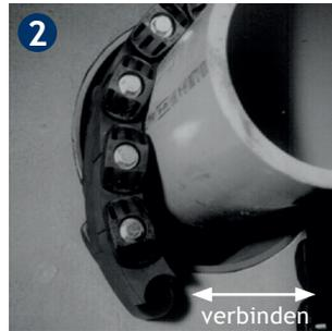
**2** Einsatz nur in geeigneten Futterrohren, Einbautoleranzen gemäß Maßangaben im Berechnungsprogramm. Hier sind die ausgewiesenen Spannbereiche zu beachten. Dies gilt auch für die Abmessungen der Medienleitungen. Mit geeigneter Dichtfläche in der Innenwandung und Steifigkeit (Formstabilität nach Einbau) des Futterrohres. Verbinden Sie die beiden Enden der Kette. Lösen Sie die hintere Druckplatte nur soweit, dass sich der Dichtring frei bewegen lässt.
