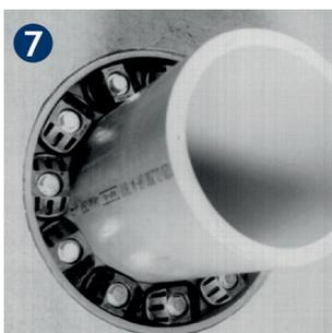
**7** Schraubvorgang nach 2 Std. wiederholen. Abhängig von den Einbaubedingungen (Ringraum, Temperatur, etc.) ggf. mehrfach nachziehen. Dies gilt im besonderen für die LS 500 bis LS 700.
