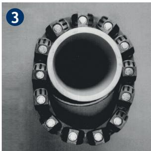
**3** Alle Schraubköpfe müssen in Richtung des Monteurs zeigen. Ein evtl. Durchhängen der Kette ist normal. Entfernen Sie KEINE Segmente. Bei kleineren Rohren kann es erforderlich sein, dass die Kette bei der Montage gedehnt werden muss!
