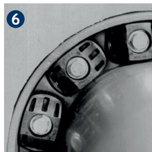
**6** Ziehen Sie jede Schraube MAXIMAL 4 Umdrehungen an. Wiederholen Sie den Vorgang im Uhrzeigersinn ungefähr 2 bis 3 mal, bis das Elastomer gleichmäßig zwischen allen Druckplatten hervorquillt und der angegebene Drehmoment (s. Tabelle) erreicht ist.
