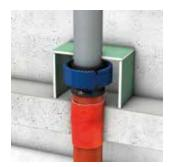
Die Abschottung Curaflam® Konfix<sup>Pro</sup> (ggf. inkl. weiterer Rohrleitungen) muss hinter einer Vorsatzschale aus mindestens 9,5 mm dicken nichtbrennbaren zement- bzw. gipsgebundenen Bauplatten (z. B. Gipskartonbauplatten) oder in mindestens 50 mm dicker Massivbauweise verkleidet sein.
