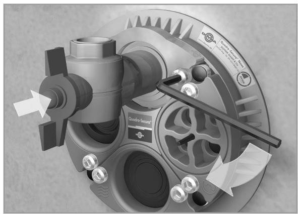
Gas Hauseinführungskombination in entsprechendes Gewerk einführen.
