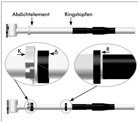
Abdichtelemente (A) und Ringstopfen (R) (dem Zubehörbeutel entnehmen) und auf die Gas-Hauseinführungskombination schieben.
