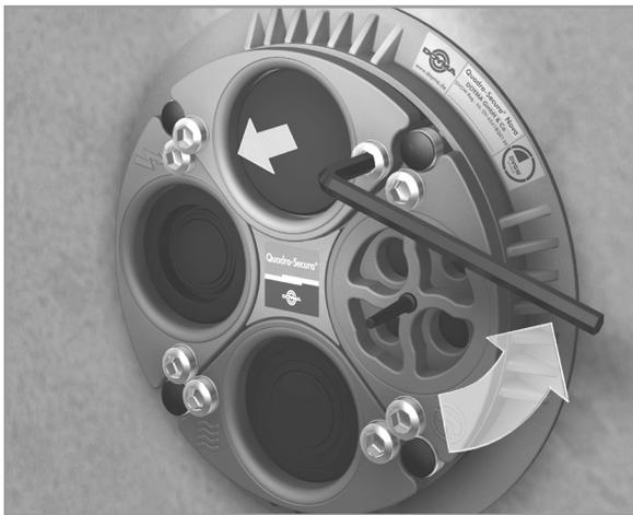
Befestigungsschrauben (Innensechskantschraube) des „Blindmoduls“ lösen. Abdichteinheit mit dahinterliegendem Ringstopfen (Sekundärdichtung) herausziehen.
