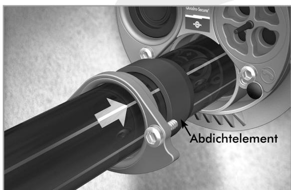
Abdichteinheit montieren: Das Abdichtelement ist mit einem Gleitmittel zu versehen (DOYMA 2780).
