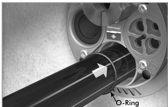
Wasserleitung durchschieben. O-Ring (Sekundärdichtung, im Zubehörbeutel enthalten) auf die Wasserleitung schieben. Der O-Ring ist mit einem Gleitmittel zu versehen (DOYMA 2780). Danach Wasserleitung mit O-Ring von der Gebäudennenseite ca. 30 cm zur Gebäudeaußenseite schieben (Position O-Ring siehe Skizze).
