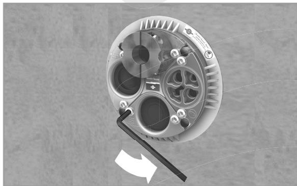
Befestigungsschrauben (Innensechskantschrauben) der Stopfbuchsbrille Wasser lösen.
