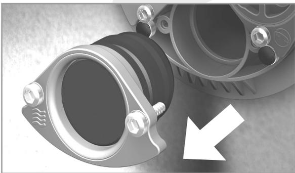
Stopfbuchsbrille und Abdichteinheit herausziehen. Anschließend Blindstopfen entfernen.
