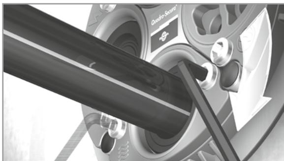
Befestigungsschrauben (Innensechskantschrauben) abwechselnd anziehen bis die Stopfbuchsbrille an der Ankerplatte plan anliegt.
