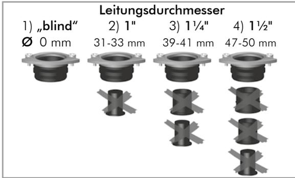
Blindstopfen aus der Abdichteinheit entfernen und entsprechend dem Durchmesser der Wasserleitung die Moduldichtung anpassen.
