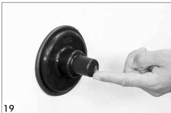
Um ein besseres Gleiten der SpeedNet-Rohre zu gewährleisten, wird empfohlen, die beiden Öffnungen des Außenflansches sowie die SpeedNet-Rohre mit Gleitmittel einzufetten.
