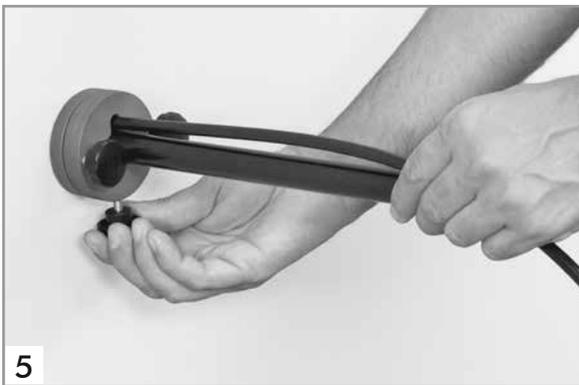
Stützen der Schnellspannvorrichtung in Bohrung einführen (bis die Spannvorrichtung an der Wand anliegt). Anschließend die Vorrichtung mittels der vertikalen Schraube feststellen. Das Rohr ist nun fixiert.
