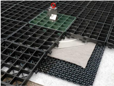
Durch Auflast gehaltene Anschlageinrichtung gemäß DIN EN 795:2012 Typ E. Einzelanschlagpunkt für kurzzeitige Arbeiten mit einer Persönlichen Schutzausrüstung (z. B. ZinCo Fallnet® PSA-Set, Art.-Nr. 9024) auf Flachdächern mit max. 5° Dachneigung.
