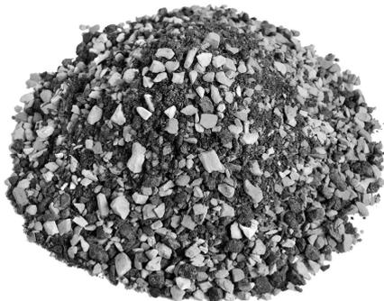
Vegetationssubstrat für extensive Dachbegrünungen in ein- oder mehrschichtiger Bauweise.
