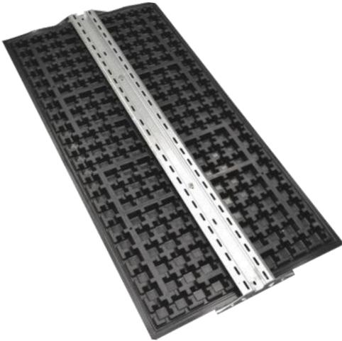
Durch Auflast gehaltene Konstruktionsbasis für durchdringungsfreie Fluchtweg-Lösungen auf Flachdächern mit beidseitigen Geländern im Abstand bis 1,86 m. Die erforderliche Auflast wird durch den im Splittbett zu verlegenden Plattenbelag erbracht.
