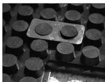
Die EL 202-Platten lassen sich durch aufsteckbare Verbinder fixieren.
