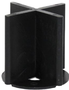
Abbildung 5: extra hohes Fugenkreuz mit Bodenplatte (52mm Fugenhöhe)
