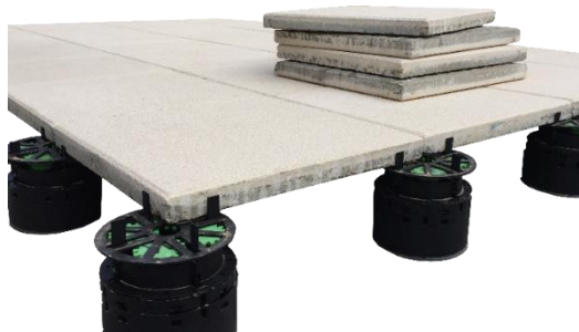
Abbildung 10: Beispielaufbau. Volfiplatte gummiert VP-GKU als Entkopplung unter VT-U50, 2x VT-B und ZR-V. Als Trittschalldämmung VT-A 2,5mm auf ZR-V aufgelegt.
