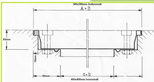
Abbildung 3: Skizze Abmessungen SA-VB
