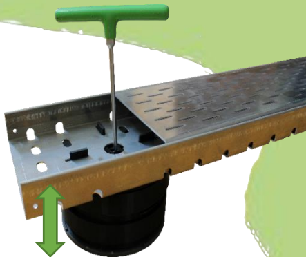
Abbildung 2: Kastenrinne aufgestellt auf Stelzlager TL-V mit eingesetztem VOLFI Stellschlüssel zur nachträglichen Feinjustierung.
