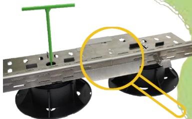
Abbildung 2: WD-Z lassen sich durch die spezielle Lochung auf feste und stufenlos verstellbare Stelzlager aus dem VOLFI-System aufsetzen. Bei Verwendung von mehreren 2,0m langen Schienen werden die Elemente durch Steckverbinder verbunden
